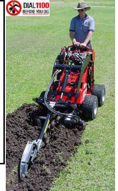
K93 Dingo Trencher
